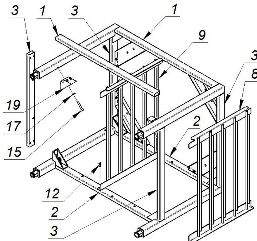
Перед фиксированием стяжки поз. 1 вставьте внутрь конструкции Держатели полок поз. 8 и поз. 9 (выступы у держателей должны войти в вырезы передних стяжек поз. 1) и закрепите каждый держатель дополнительно двумя болтами поз. 12.
