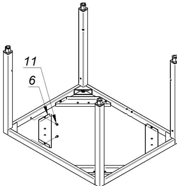
3. Переверните конструкцию на бок и закрепите остальные стяжки описанным в п.1 способом, при этом стяжки одинаковых позиций (одинаковой конструкции) должны находиться друг под другом.
