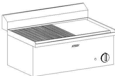
Предназначен для поджаривания различных продуктов на плоской или ребристой поверхности сковороды. Нагрев сковороды осуществляется 2-мя ТЭНами (под ребристой и под гладкой поверхностью) мощностью 1,6 кВт. Терморегуляторы отключают нагрев каждого ТЭНа. Регулировка температуры от 50 до 300°C. Регулятор температуры позволяет проводить плавную регулировку нагрева поверхности электросковороды. Время достижения температуры 260°C не более 20 минут.
