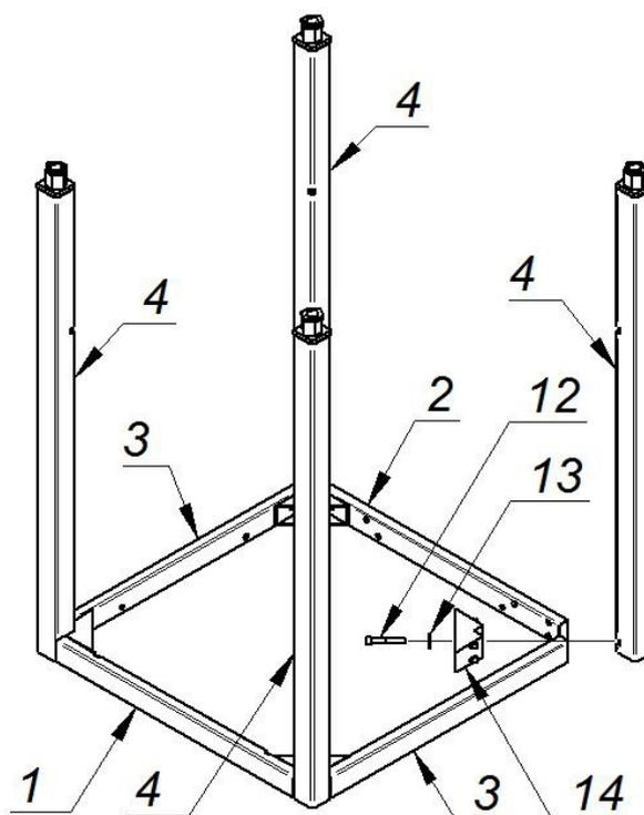
Присоедините к Стяжкам поз. 2 и поз. 3 Ножку поз. 4 с внешней стороны и Угловой крепеж поз. 14 с внутренней стороны и стяните их друг с другом с
