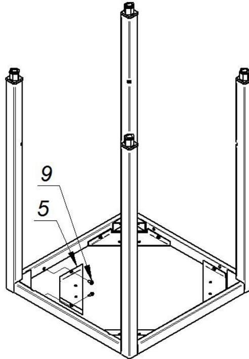
3. Переверните конструкцию на бок и закрепите оставшиеся стяжки описанным в п.1 способом, при этом стяжки одинаковых позиций (одинаковой конструкции) должны находиться друг под другом.
