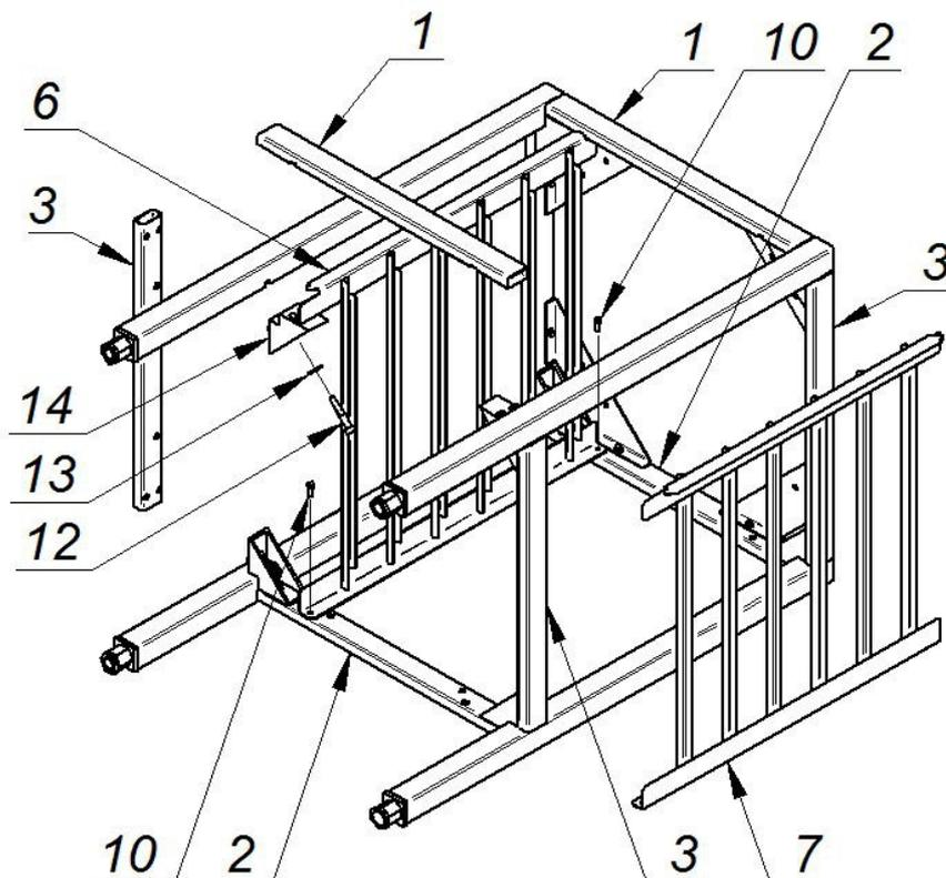
Перед фиксированием стяжки поз. 1 вставьте внутрь конструкции Держатели полок поз. 6 и поз. 7 (выступы у держателей должны войти в вырезы передних стяжек поз.1) и закрепите каждый держатель дополнительно двумя болтами поз. 10.
