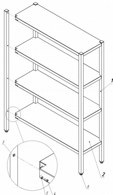
1. Стойки (поз. 1) стеллажа имеют регулировочные опоры (поз. 6), позволяющие придать стеллажу устойчивое положение. Стойки имеют гайки-заклепки, которые при сборке совмещаются с отверстиями полок (поз. 2).
