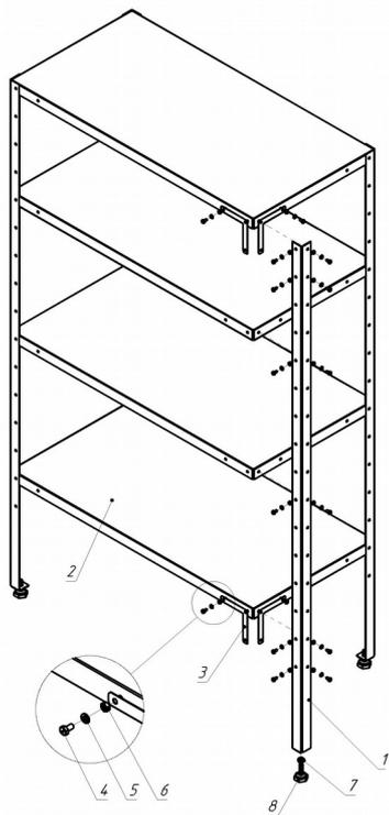
1. Стойки (поз. 1) стеллажа имеют регулировочные опоры (поз. 8), позволяющие придать стеллажу устойчивое положение.
