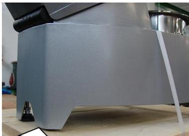
Если машина плохо установлена, отрегулируйте заднюю ножку
