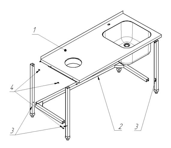
Рис.1 СПСО-7-5 1-столешница, 2-основание, 3-ножка, 4-болт M6x14.68.019 ОСТ 37.001.193-83.
