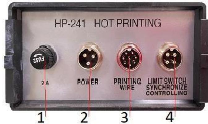
Подключить блок управления датером при помощи разъёмов ПИН-3, ПИН-8, ПИН-4 в соответствующие гнезда 2, 3, 4.. Проверить предохранитель в гнезде 1.
