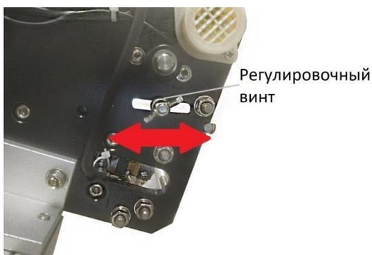
При печати даты в 2-3 строки необходимо произвести регулировку протяжки риббона во избежание попадания использованной части риббона под литеру при следующей печати. Длина протяжки риббона настраивается перемещением регулировочного винта вдоль установочного отверстия.
