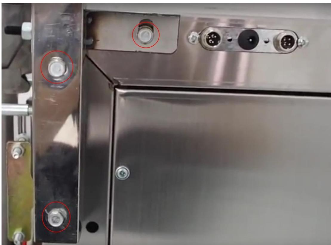
Таким образом вы устанавливаете стойку, фиксируя несколько болтов.
