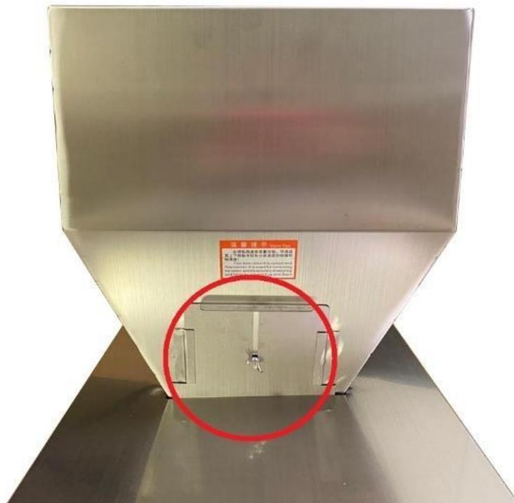
На загрузочном бункере установлена заслонка для регулировки высоты потока продукта.
